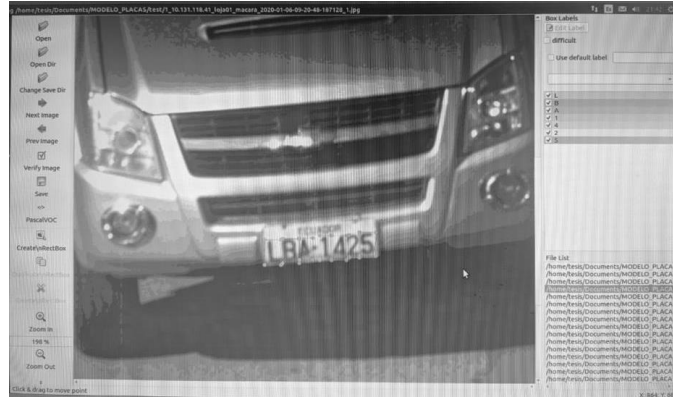
Figura 6. Herramienta ImgLabel para etiquetado manual del dataset de fotos.
