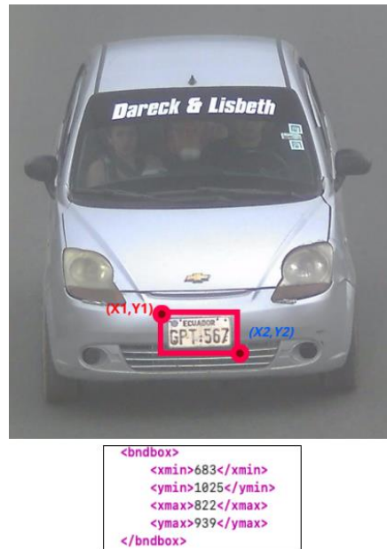
Figura 7. Plantilla XML generada por el etiquetado manual, previo al entrenamiento.
