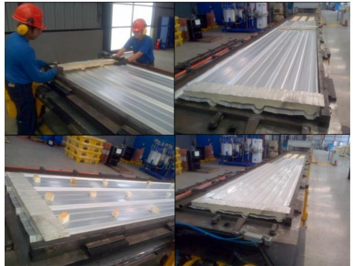
**Figura 5.** Proceso de fabricación de panel inyectado
