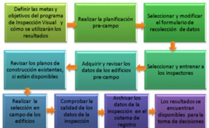
**Figura 7.** Pasos a seguir para la recopilación de información para obtener el índice de vulnerabilidad sísmica de las viviendas en estudio.
