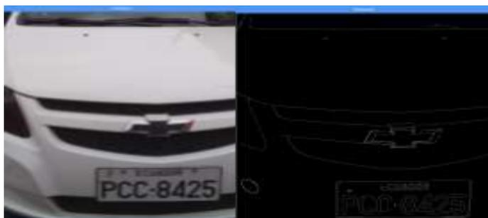
**Figure 6.** Canny Edge Detection.
