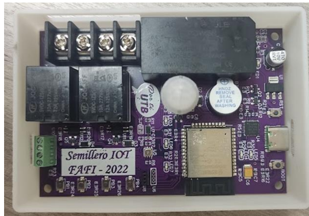
Figura 6. Vista al interior del prototipo ensamblado
