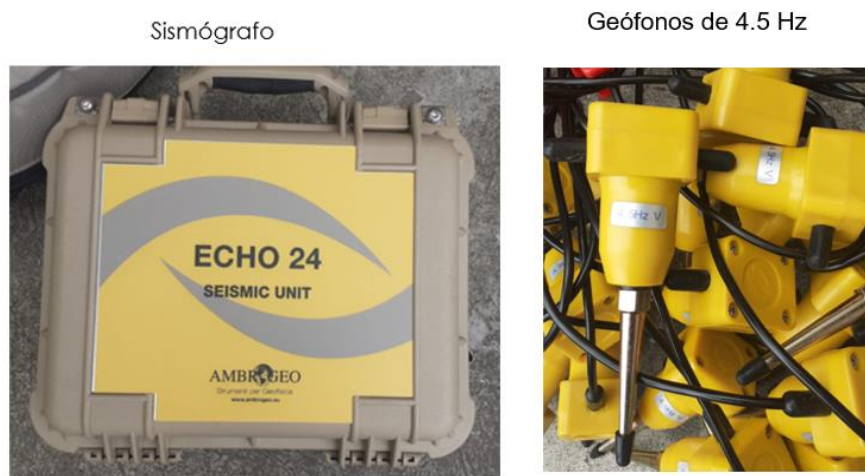
Figura 2: Equipos para prospección geofísica con sismógrafo y geófonos de 4,5 Hz con la instrumentación Ambrogeo
