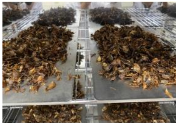
Figura 2. Secado de la fibra a 80°C por 20 minutos
