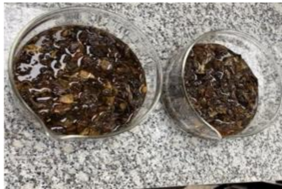
Figura 1. Fibra de gándul en solución de hidróxido de sodio al 0,1 molar
