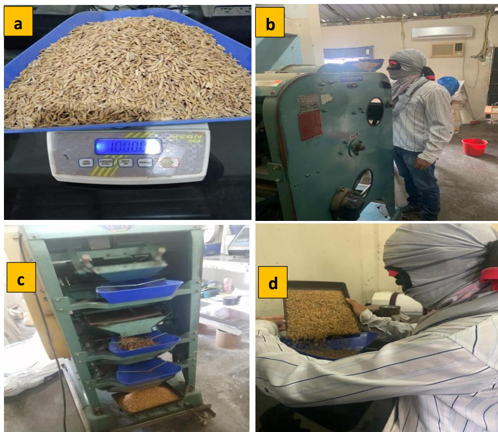
Figura 1. Peso de 1000 gramos de muestra (a), limpieza del equipo antes de proceder al uso (b), pasado de las muestras y colección de los granos limpios e impurezas (c), pesado de granos limpios (d).
