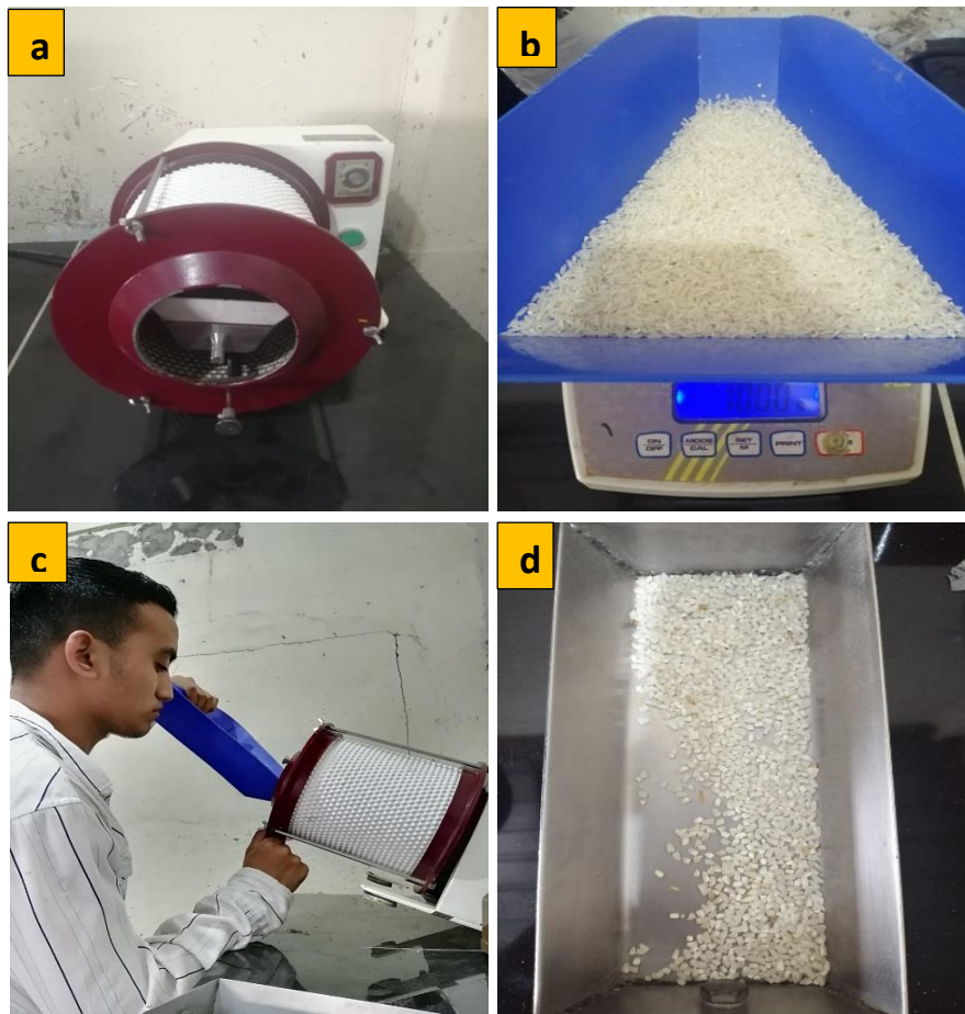
Figura 3. Cilindro clasificador (a), peso de 100 gramos en la balanza digital (b), ubicación de granos en el cilindro (c), arroz quebrado o arrocillo colectado en la muestra de 100 g (d).
