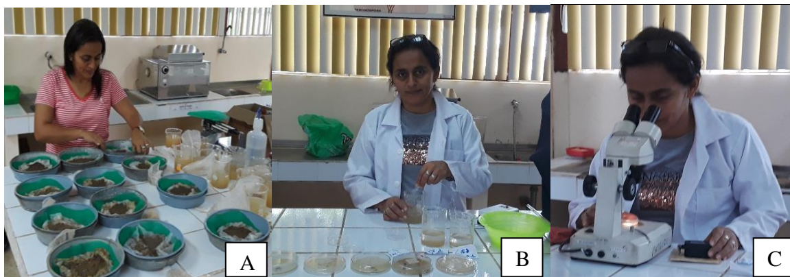
Gráfico 4. (A) Colocación del suelo en los platos de aluminio (B), recolección de las muestras en el vaso de precipitación y (C) conteo de los nematodos en 1 mL de muestra.
