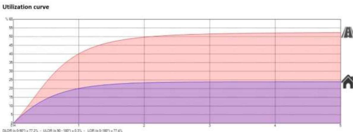
Figura 6(b): Curva de utilización de luminaria sodio de 150 W, resultados de simulación en el software Ulysse3
