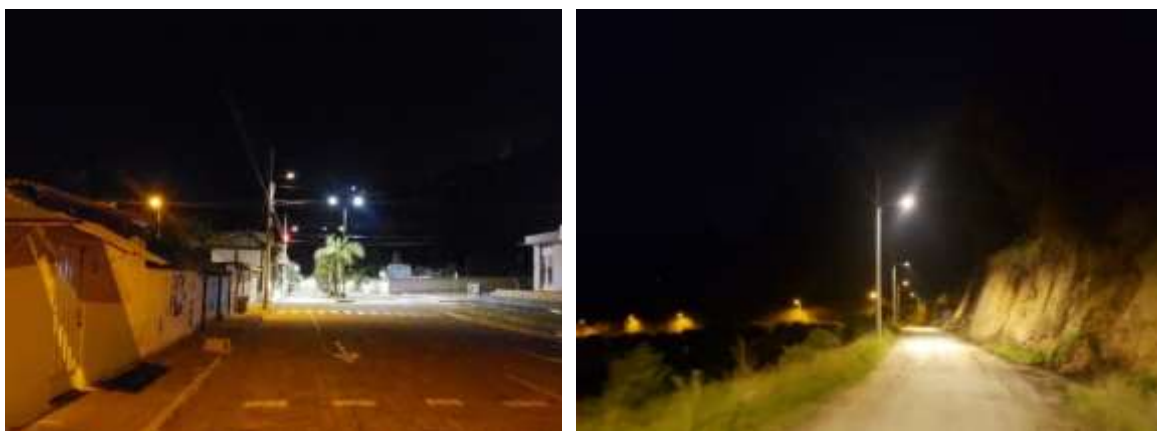
Figura 5(a),(b): Sector iluminado con luz led de 4000K e iluminación tradicional (izquierda), Sector iluminado con luz led de 2700K e iluminación tradicional al fondo (derecha)
